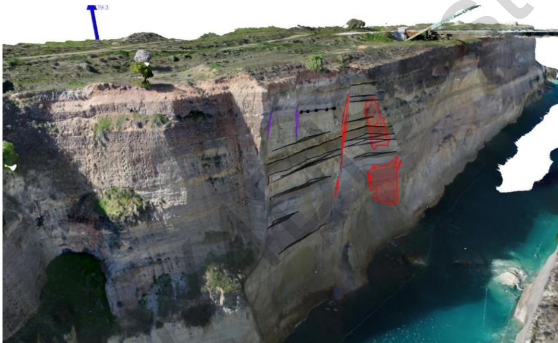
Εικόνα 3.24. Τρισδιάστατο μοντέλο από το ShapeMetriX UAV που απεικονίζει ρήγματα και τις κύριες επιφάνειες διακοπής που ελέγχουν την αποτυχία πλαγιάς της 26ης Φεβρουαρίου (επιφάνειες ρήγματος σε κόκκινο, επιφάνειες αρμών σε μπλε, επιφάνειες στρωμάτων σε μαύρο).
